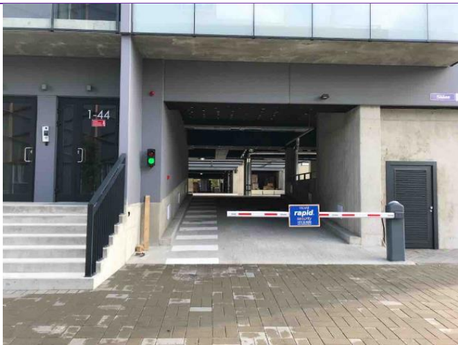
Näide korrektsest sissepääsust parklasse, kus tõkkepuu jätab ruumi jalakäijate, liikumisabivahendite jt pääsuks.
