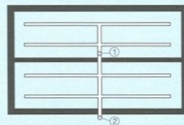
Joonis 10 Ventilatsioonitorude paigutuse skeem
