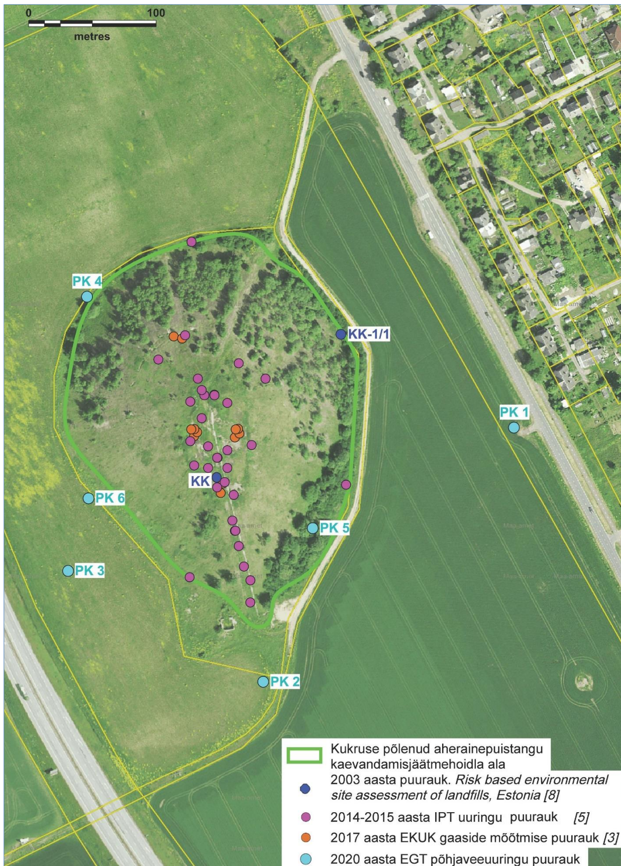
Joonis 2 Kukuruse kaevandamisjäätmeohidla ja erinevate uuringute puuraukude paiknemine
