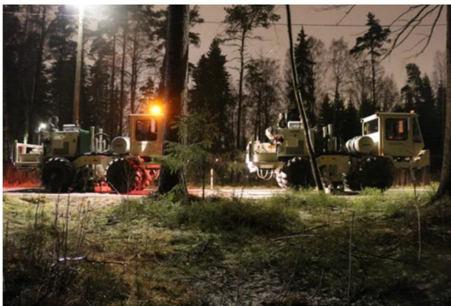
Fig. 30. Reflection seismic studies in Keskusuisto, Helsinki. (Photo GTK).
